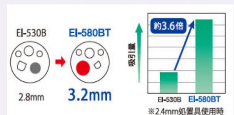
鉗子口径が3.2mmに拡大。従来使用困難であった処置具が使用可能に。また吸引力も上昇した。
